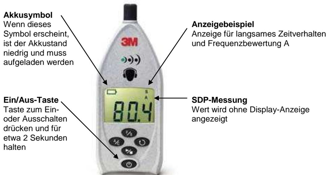
Abbildung 1-2: Eingeschaltet mit angezeigtem SPD-Display
