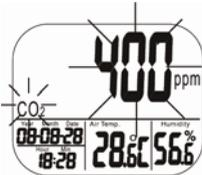
Abb. 21: Display während der CO<sub>2</sub>-Kalibrierung
