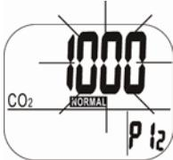
Abb. 9: Einstellung der CO<sub>2</sub>-Obergrenze für den normalen Bereich
