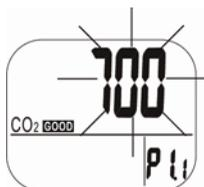
Abb. 8: Einstellung der CO<sub>2</sub>-Obergrenze für den optimalen Bereich
