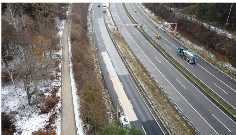
Abb. 2 Im Projekt «Kühle Strassenbeläge» werden verschiedene Asphaltmischungen in Bern getestet © Grolimund + Partner AG
