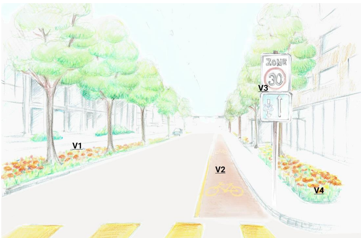
Die Kantonstrasse mit zusätzlichen möglichen Massnahmen gegen Hitze im Verkehrsraum: Begrünung des Mittelstreifens mit strassentauglichen Bäumen und Wildblumen (V1), Reduktion der Fahrbahn und mehr Platz für den Langsamverkehr (V2), Geschwindigkeitsreduktion auf 30 Km/h (V3), effektive Nutzung der Restflächen am Strassenrand (V4). (eigene Darstellung)
