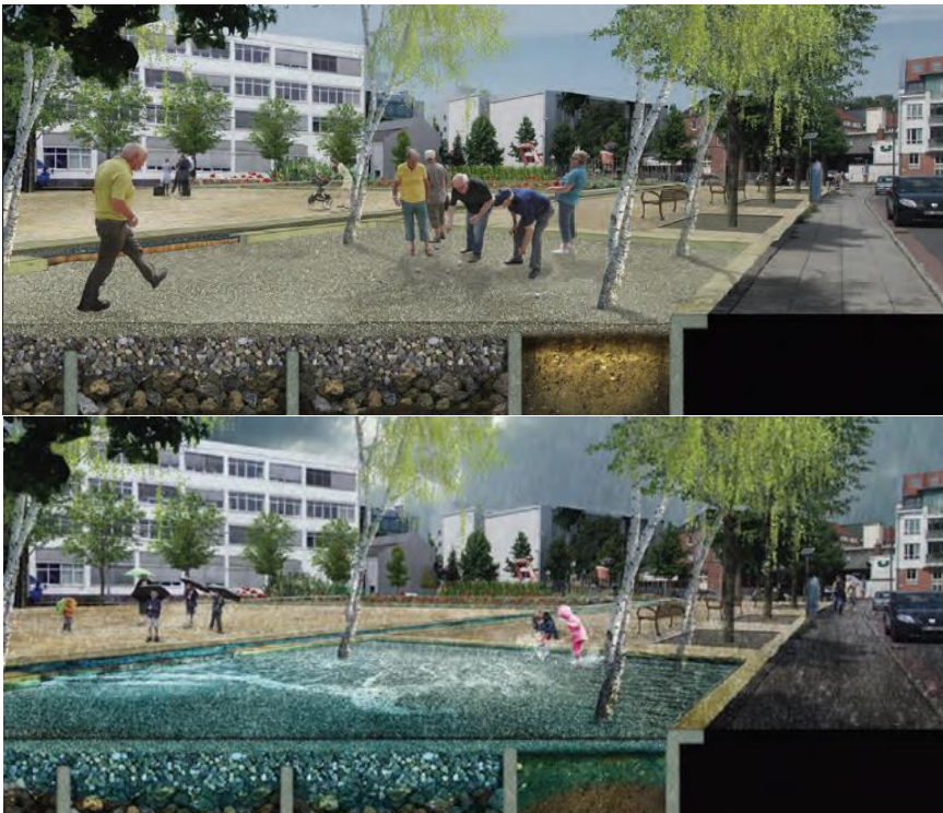
Abbildung 57 Multifunktionale Flächen – im Falle eines Starkregens dient die Boccia Spielfläche als kurzzeitiger Retentionsraum © MUST Städtebau
